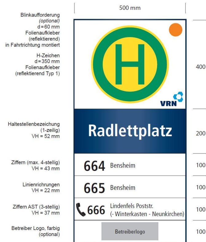
Abb. 35: Wechselschild mit gewölbter Oberfläche
