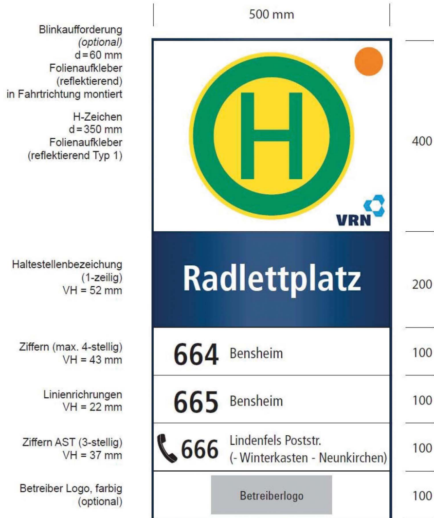
Abbildung 50: Wechselschildsystem mit gewölbter Oberfläche (höherwertiges System)
